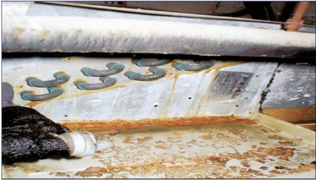
Рисунок 4. Накипь в теплообменнике
