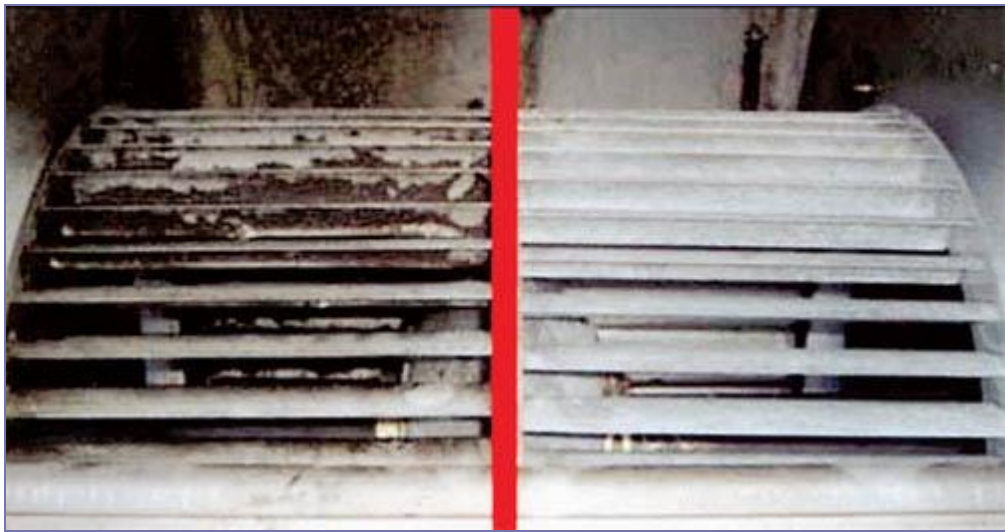
Рисунок 5. Вентилятор до и после обработки
